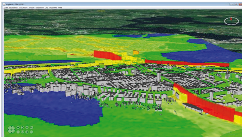
Obr. 3.6 Ukázka uživatelského rozhraní s vizualizací modelu možného vývoje znečištění ovzduší v nově zastavěné oblasti (převzato ze SUDPLAN, 2012)
